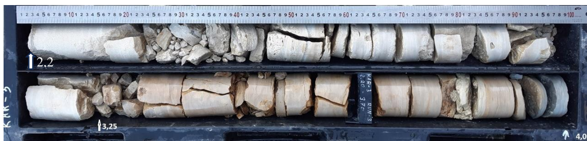
Foto 5.2. Uuringuruumi läbilõike ülaosas lasub keskmiselt 3,4 m paksuselt valkjashall peenekristalliline peeneteraline dolokivi (fotol int 2,2 - 3,25 m) ja selle all keskmiselt 2 m paksuselt beežikas afaniitne dolokivi (int 3,25 - 4,05 m).
