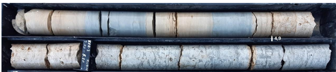
Foto 5.6. Bretšalaadse ilmega kavernide ja mudasööjakäikudega dolokivi puuraugus PA-3/24 (int 4,9 - 6,0 m), mille lasumis on afaniitne peenekihilise tekstuuriga plaatjas savikas dolokivi.
