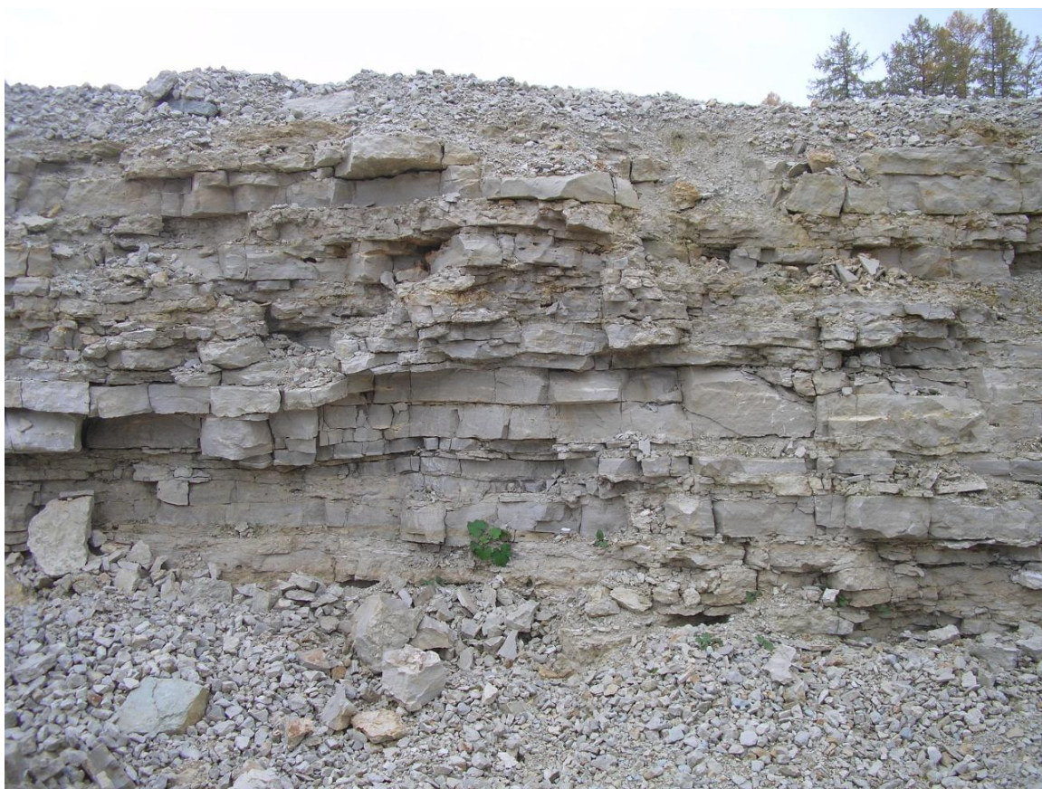
Foto 5.3. Läbilõike ülemine osa karjääri seinas – valkjasbeež peenekristalliline, peeneteraline, keskmise- kuni paksukihiline dolokivi, milles esinevad kavernoossed ja poorsed vahekihid (foto T. Tuuling okt.2013; N 58°52'16" ja E 25°45'27").
